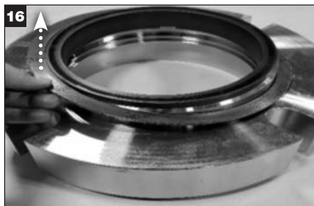
Fjern fladepakningen fra adapteren og bortskaf.
