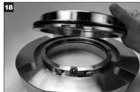
Fjern adapteren fra stopbøsningen. Fjern adapterens O-ring (Z) og bortskaf. Sæt adapteren til side.
