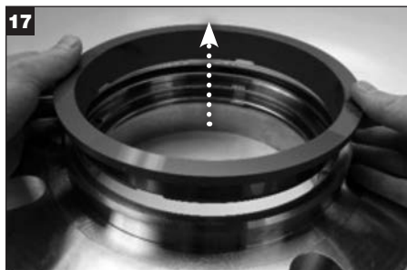
Fjern den indvendige, stationære tætningsring fra stopbøsningen og bortskaf.
