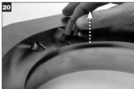
Fjern drivmontagen fra stopbøsningen og bortskaf.
